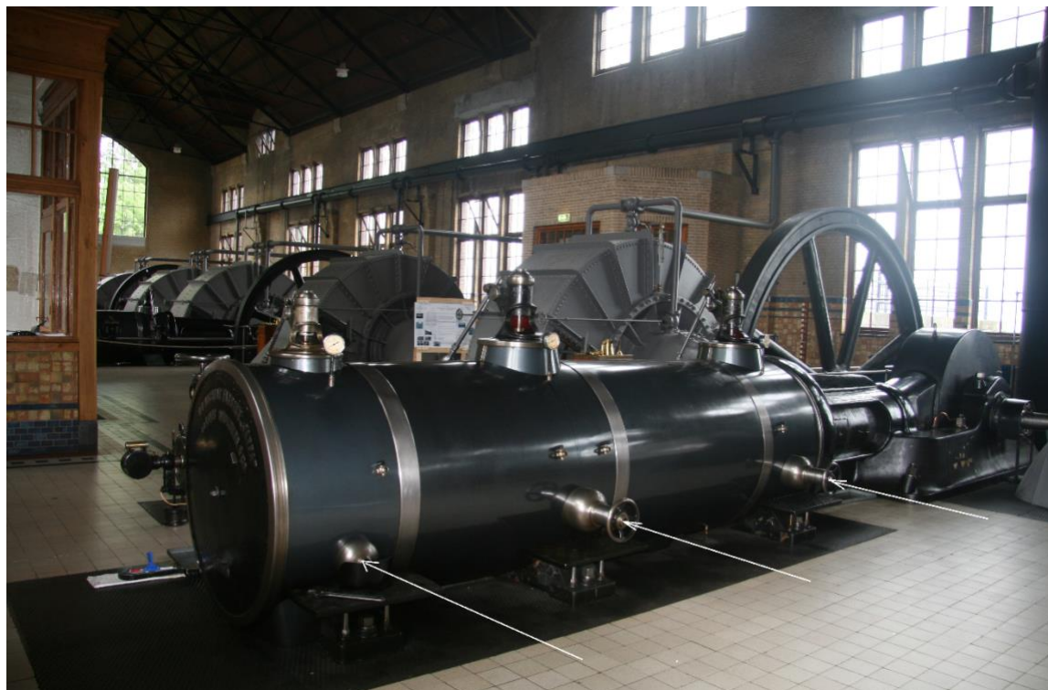
Ontlastkleppen bij de stoommachines (de pijlen wijzen naar HD en de twee LD ontlastkleppen)
